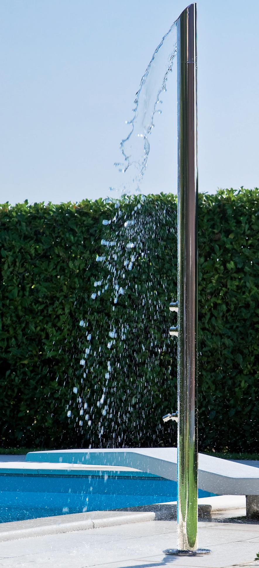
Colonna doccia AquaBambù in acciaio inox. Kit di fissaggio a pavimento per collegamento idraulico (calda e fredda) - 2 rubinetti progressivi - Diffusore doccia con getto a cascata - bocca piedi getto aerato.
